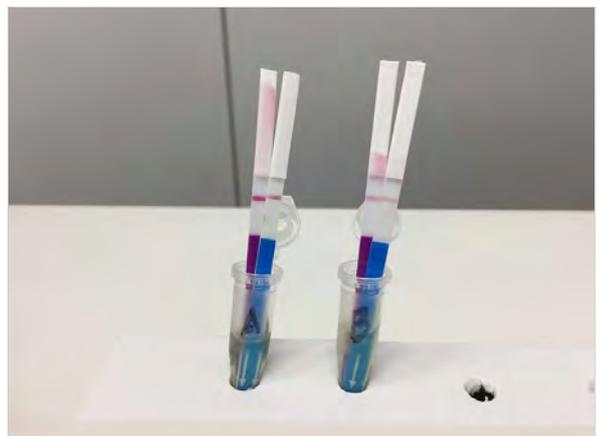
⑥試験紙を差し込んでから5～10分ほどで結果が出ます。クロマトグラフの原理で、樹液を含んだ水が試験紙に吸い上げられます。基準のところまで水が達すると、そこに基準線が現れます。
